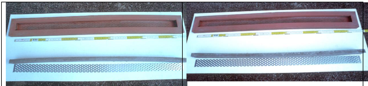
Fig. 3 - Tipico comportamento convesso di una malta che espande all'aria
