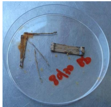
Fibre corrodibili, prova non superata
