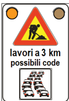
Figura 4: cartello di preavviso con lampeggiatori a led diam. 200 mm alta efficienza. Dimensioni 135x200 cm. Posizionamento sul margine destro su cavalletto a circa 3.000 m dal triangolo "lavori in corso".
