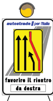
Figura 5: pannello composto di presegnalazione in destra modificabile con lamierini integrato con lampeggiatore a led alta efficienza diam. 300 mm alimentato con batteria da autovettura. Dimensioni 135x200 cm. Posizionamento sul margine destro su cavalletto con anticipo rispetto al cartello "lavori in corso" come da schemi in cui se ne prevede la dotazione.
