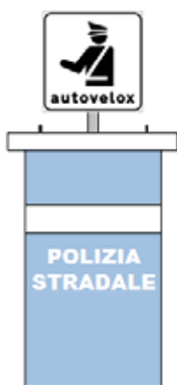
Figura 9: box autovelox mobile per cantieri di lavoro (tipo standard approvato dalla Polizia Stradale)
