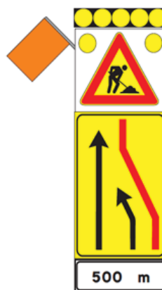
Figura 12: "segnale mobile di preavviso" fig. Il 400 Art.39 Reg. da impiegare su tratti autostradali con corsia di emergenza per la chiusura di una o più corsie di transito (la figura esemplifica la chiusura della corsia di marcia in dx). E' integrato con set di 6 lampade a led ad alta efficienza luminosa diam. 300 mm (con possibilità di lampeggio sincrono e sequenziale) e con sbandiatore elettromeccanico posto in alto sul lato esposto al traffico.
