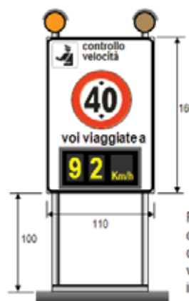
Figura 10: cartello di preavviso 90x135 da posizionare su cavalletto in anticipo rispetto alla posizione del box autovelox mobile
