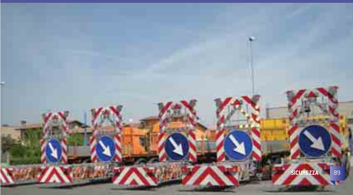
Tipo di presegnalazione per cantiere mobile in corsia di emergenza
